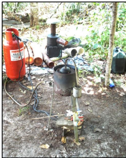
Retortas introducidas por la CDA para separar el oro. Río Inírida, octubre 2002
