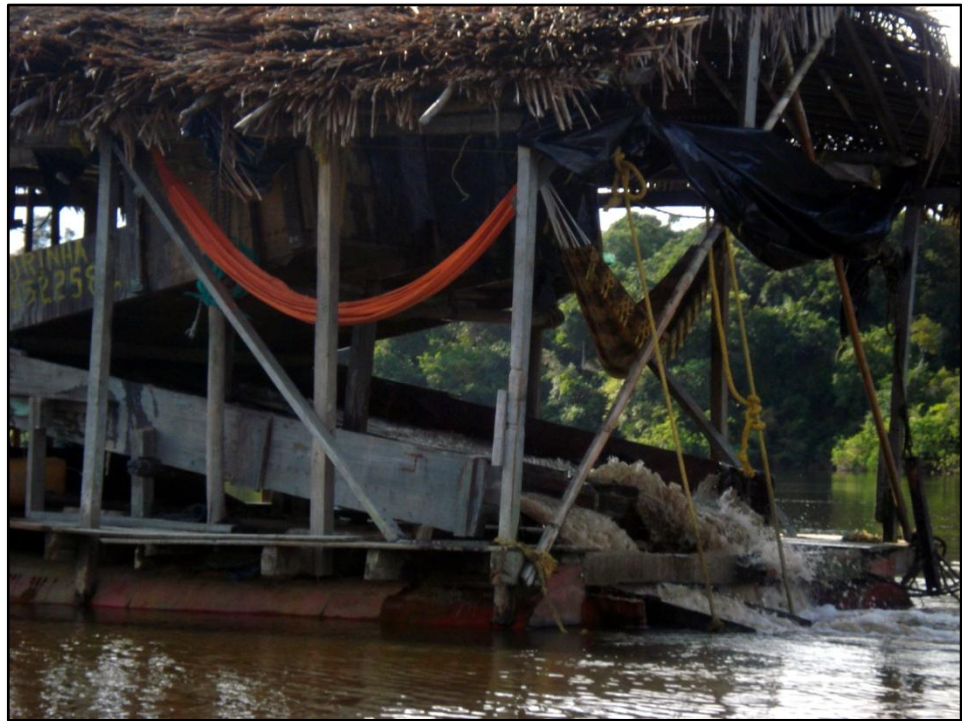
Detalle de cama y canaletas en balsa minera. Foto: Diana Alexandra Mendoza, octubre 2012
